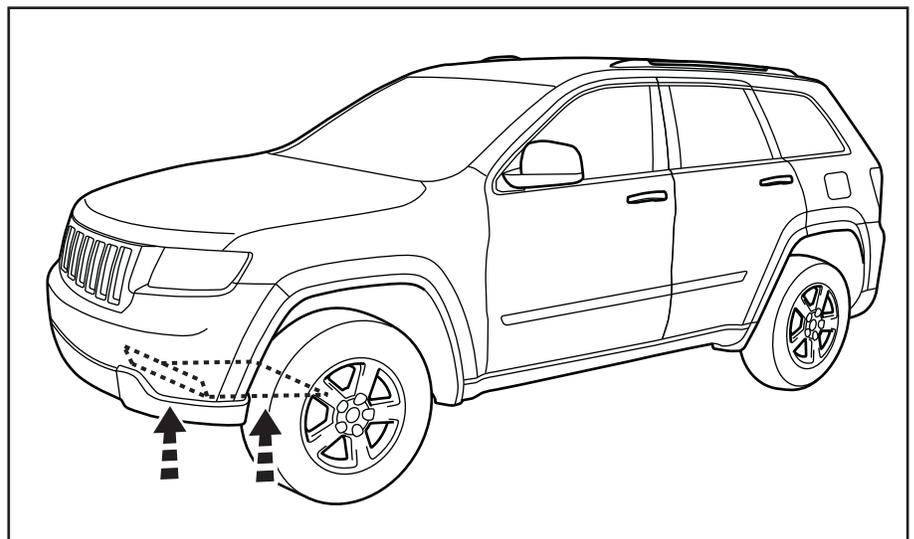
2. Boulonnez la plaque de protection du carter en place à l'aide de quatre (4) boulons de 13 mm et serres-écrous fournis, comme montré. Serrer avec un couple de 19 Nm (14 po/lb).
