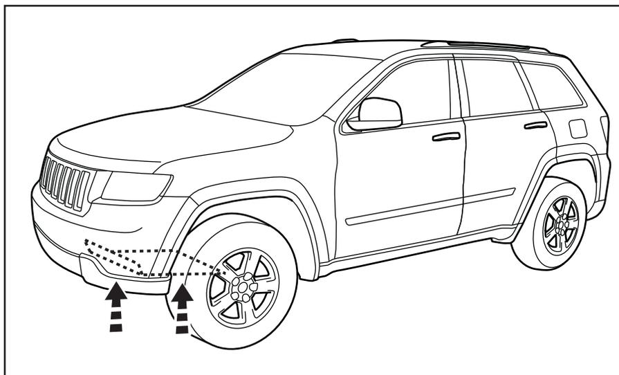
2. Fije la placa protectora delantera en su lugar, como se ilustra, utilizando los cuatro (4) pernos de 13mm y las cuatro (4) tuercas de presilla que vienen incluidos. Apriete los tornillos a 19 Nm (14 lb in).
