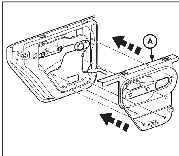
3. Instale los 2 tornillos de cabeza Phillips largos (C) a través de los agujeros superiores del panel de la vestidura de la puerta (A). Apriételos con un destornillador Phillips.
