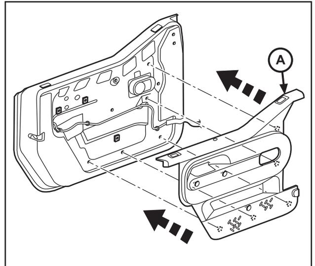
3. Installez deux (2) vis Phillips longues (D) dans les trous du panneau de porte du haut (A) et serrer avec un tournevis Phillips.
