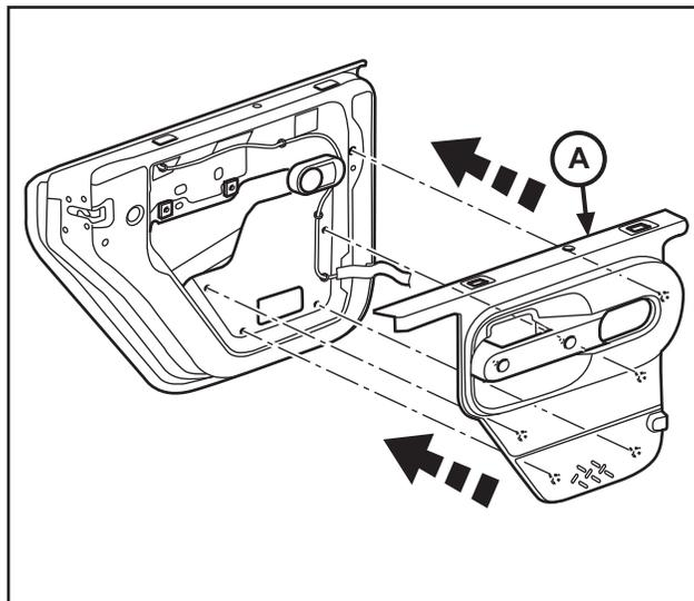
3. Installez deux (2) vis Phillips longues (C) dans les trous du panneau de porte du haut (A) et serrer avec un tournevis Phillips.
