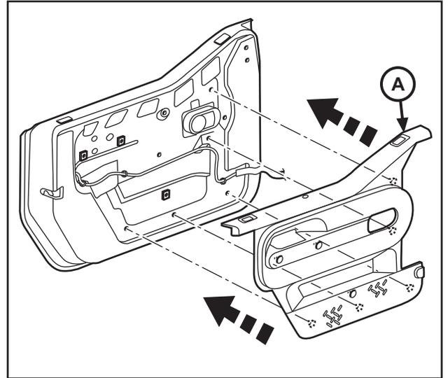
3. Instale 2 tornillos de cabeza Phillips largos (D) a través de los agujeros superiores del panel de vestidura de puerta (A). Apriételos con un destornillador Phillips.
