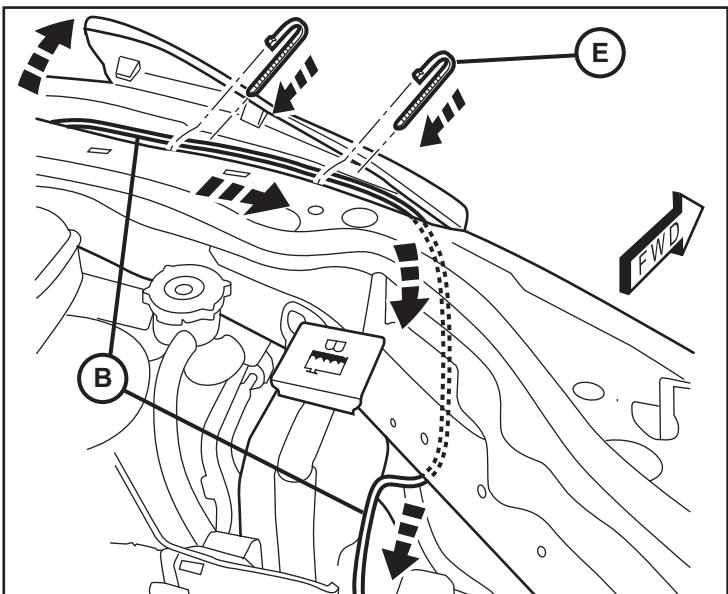
8. Encause el mazo del interruptor (B) junto con los mazos existentes en el vehículo sobre el lado del pasajero y de regreso hacia la parte trasera del compartimiento del motor.
