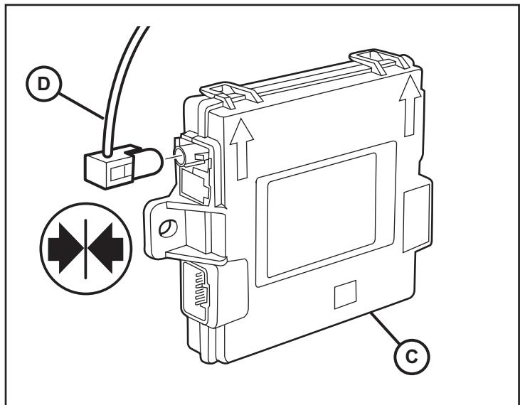
34. Coloque el nuevo Módulo de distribución RF (C) en su posición. Sujete el Módulo de distribución RF en la pared utilizando dos (2) tuercas hexagonales de sujeción (F) y vuelva a conectar todos los conectores de los mazos.
