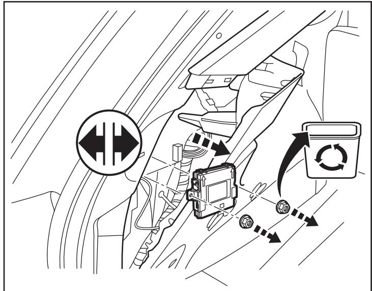
33. Enchufe el cable del Módulo de la antena (D) al nuevo módulo de distribución RF (C).
