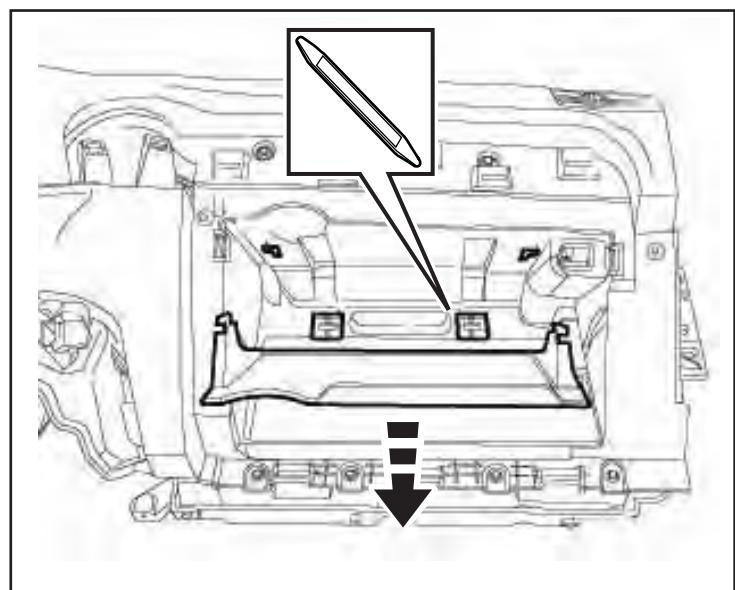
18. Déposez quatre (4) attaches du bord du fond et deux (2) autres cachés sous les pare-chocs de caoutchouc au dessus du pourtour du coffre à gants. Débranchez un (1) connecteur électrique se trouvant sur le côté droit du coffre à gants. Déposez et sortez le pourtour du coffre à gants du véhicule.
