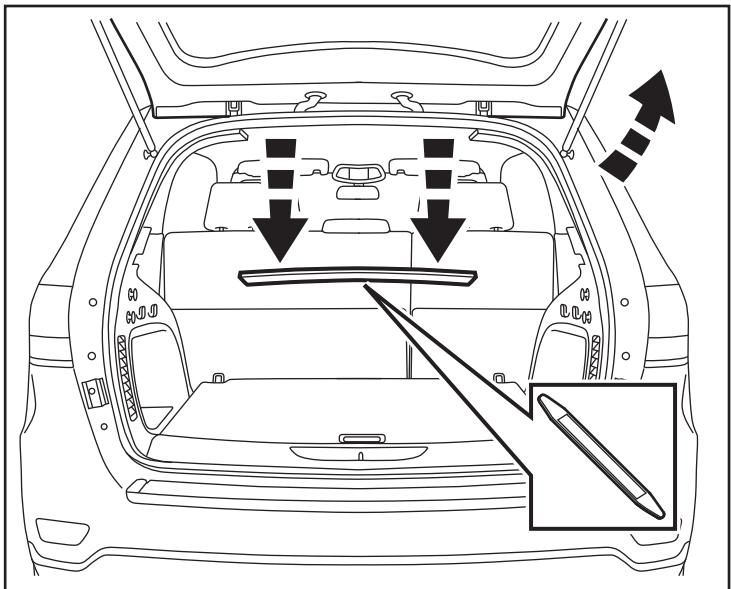
29. Déposez les deux (2) attaches du panneau protecteur de seuil. Mettez le panneau en lieu sûr hors du véhicule.
