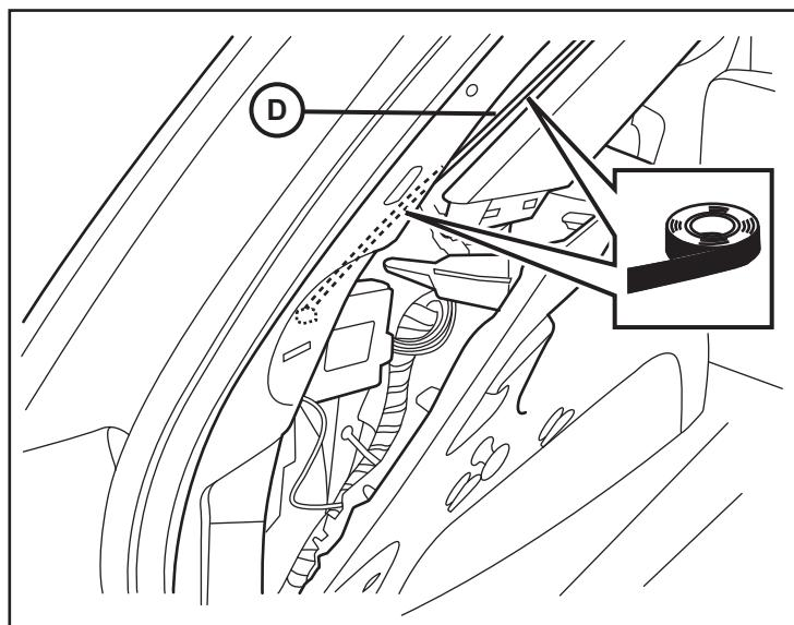
39. Revise todo los cables y recorte todos los sujetacables.
