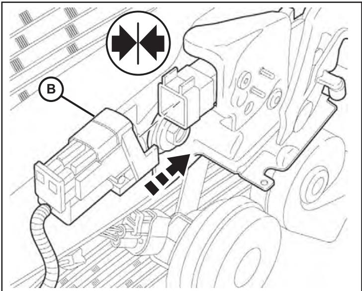
7. Soulevez délicatement le panneau recouvrant le radiateur. Acheminez le faisceau de câbles du commutateur (B) le long du faisceau de câbles principal du véhicule, en direction du côté du passager. Poussez le faisceau de câbles sous l'entretoise du haut pour qu'il sorte à côté du réservoir du lave-vitre. Fixez les deux faisceaux ensemble avec des serre-câbles (E).
