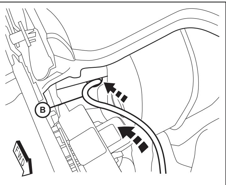
21. Coupez la membrane du passe-câble et poussez-y le faisceau de câbles du commutateur.
