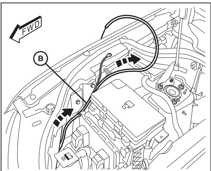
9. Dentro de borde el guardabarros, quite la tuerca hexagonal grande. Coloque el terminal en anillo de conexión a tierra del mazo del interruptor sobre el espárrago (B) y vuelva a fijar la tuerca para sujetar.
