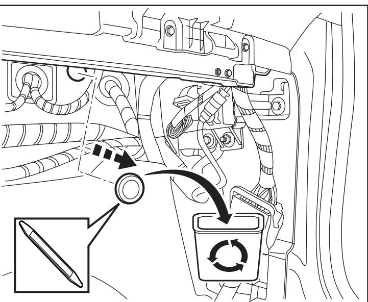
20. À partir du compartiment moteur, poussez le faisceau de câbles du commutateur (B) dans le trou du passe-câble et dans le puits de jambe côté passager.
