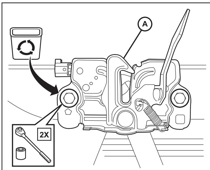
**REMARQUE :** Il se pourrait qu'un faisceau de câbles de commutateur d'origine soit présent. Si c'est le cas, détachez le connecteur, acheminez-le sous l'entretoise et branchez-le dans l'ensemble de verrouillage du capot, puis passez à l'étape 28.
