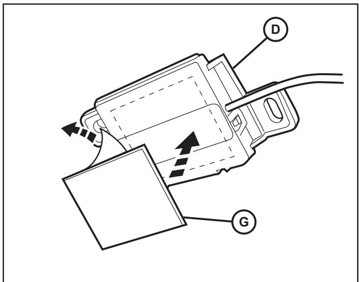
37. Pelez l'autre côté du panneau adhésif recto verso (G) et fixez le module d'antenne (D) à l'intérieur du panneau de garniture du toit. Acheminez le câble de raccordement vers le montant du hayon arrière côté conducteur à l'intérieur des panneaux de garniture.
