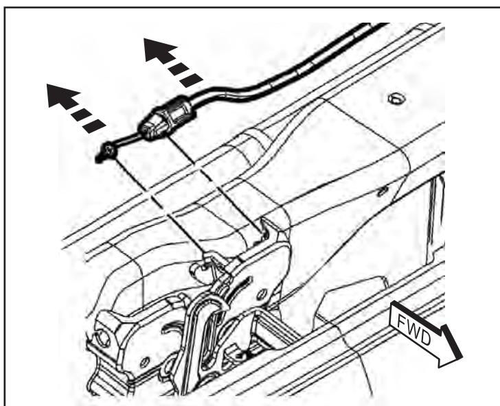
5. Rebranchez le câble de déverrouillage du capot à l'arrière du nouvel ensemble de verrouillage. Alignez le nouveau verrou de capot (A) sur les marques d'alignement et fixez-le avec deux (2) boulons hexagonaux. Serrez les boulons au couple de 11 N·m (8 lb·pi).
