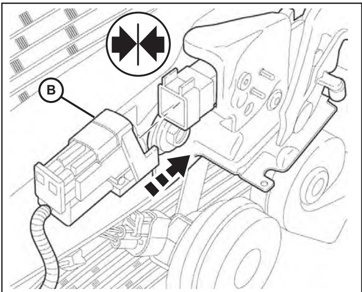
7. Desprenda con cuidado el panel de cubierta del radiador. Encause el mazo del interruptor (B) hacia el lado del pasajero junto con el arnés del vehículo existente. Pase el mazo del interruptor por debajo del travesaño para que salga cerca de la botella de líquido del lavaparabrisas. Sujételo con un sujetacables (E).
