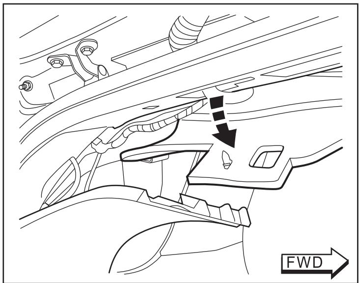
36. Desprinda un lado del panel con doble lado adhesivo (G) y colóquelo sobre el lado de la etiqueta del Módulo de la antena (D).
